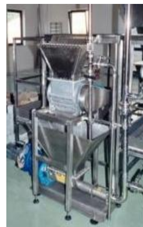
Fig. 7.29. Zdrobitor cu ciocane fixe (sursa:www.damartrading.bizoo.ro)
