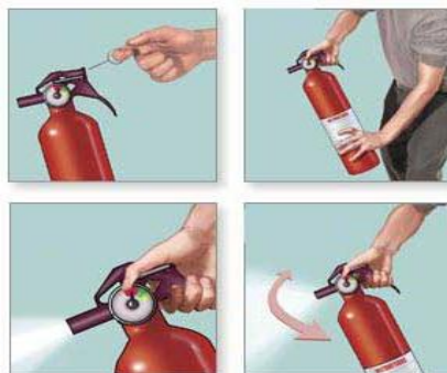
Fig.14.1. Modul de utilizare a stingătorului de incendiu
