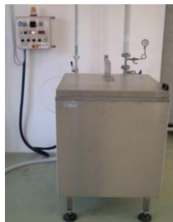
Fig. 7.15. Vas de opărire pe șarje a legumelor și fructelor (sursa:www.damartrading.bizoo.ro)
