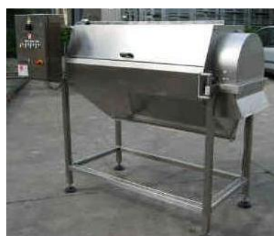
Fig. 7.32. Mașina de tăiat capetele la fasolea verde (sursa:www.damartrading.bizoo.ro)
