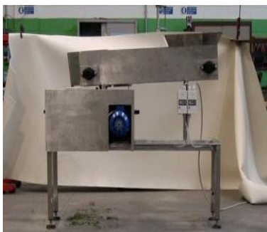
Fig. 7.28. Mașina de tăiat ciuperci cu lame încrucișate (sursa:www.damartrading.bizoo.ro)
