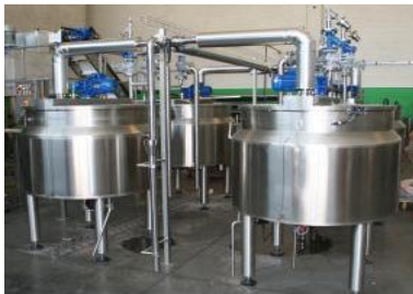
Fig. 7.35. Cazanul duplicat cu agitator (sursa: www.damartrading.bizoo.ro )
