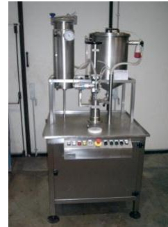
Fig. 7.42. Subansablurile mașinii de dozat liniară (sursa: www.damartrading.bizoo.ro )
