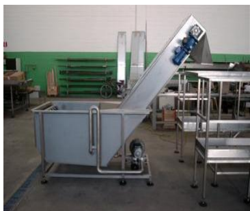
Fig 7.9. Mașina de spălat legume și fructe (sursa:www.damartrading.bizoo.ro)
