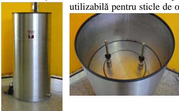
Fig. 7.54. Mașina de clătit semiautomată (sursa: www.damartrading.bizoo.ro )
