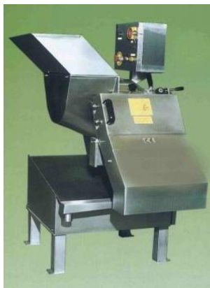
Fig. 7.27. Mașina de cubetat tip CUB TEC
