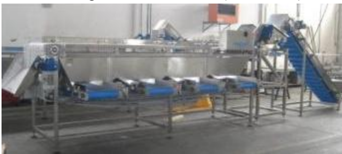
Fig. 7.5. Calibrator (tip 205) pentru morcovi și castraveți (sursa:www.damartrading.bizoo.ro)
