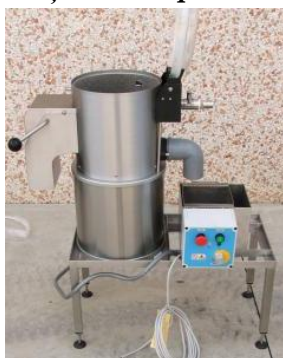
Fig 7.12. Mașina de depelat universală abrazivă (sursa:www.damartrading.bizoo.ro)
