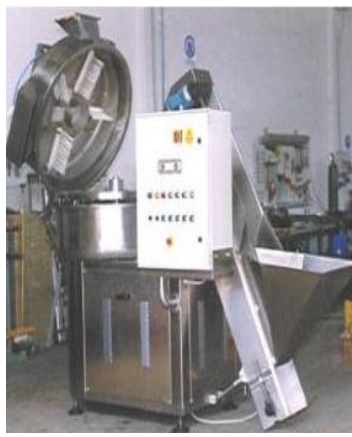
Fig. 7.13. Mașina de curățat usturoi și ceapă cu aer (sursa:www.damartrading.bizoo.ro)
