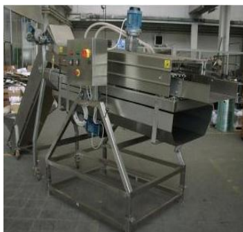
Fig. 7.31. Mașina de îndepărtat codițe (sursa:www.damartrading.bizoo.ro)
