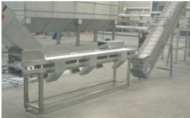
Fig 7.4. Linie de sortare produse (sursa:www.damartrading.bizoo.ro)
