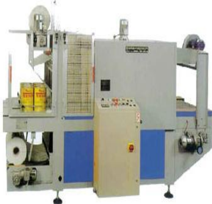
Fig. 7.53. Mașina de baxat semi-automată (sursa: www.damartrading.bizoo.ro )
