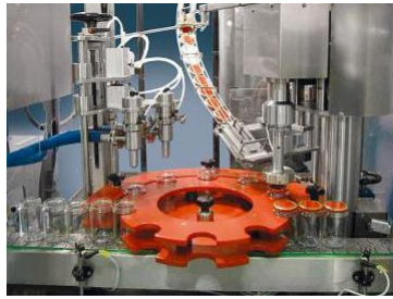
Fig. 7.42. Subansablurile mașinii de dozat liniară (sursa: www.damartrading.bizoo.ro )
