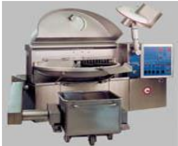
Fig. 7.26 (a,b,c) Cuterul Tehnofrig (imagine, secțiune, schema cinematică)
