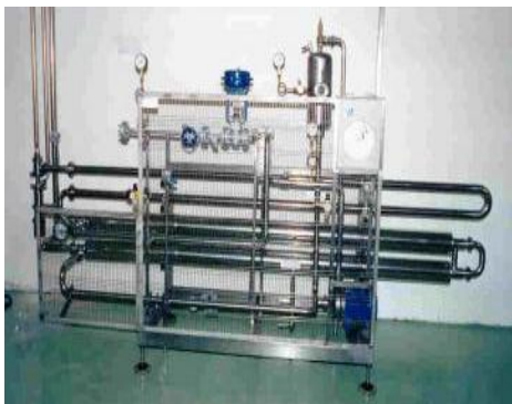
Fig. 7.17. Opăritor continuu tubular (sursa:www.damartrading.bizoo.ro)
